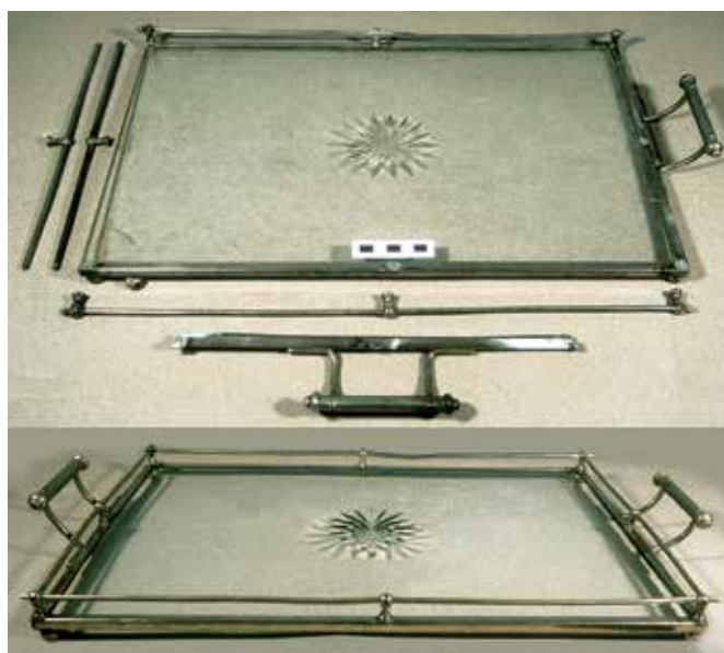
14. Αρχική και τελική κατάσταση ενός δίσκου από γυαλί με σπασμένο μεταλλικό πλαίσιο και λαβές. (α) Αποκολλημένα και σπασμένα μέρη. (β) Αποκατάσταση
